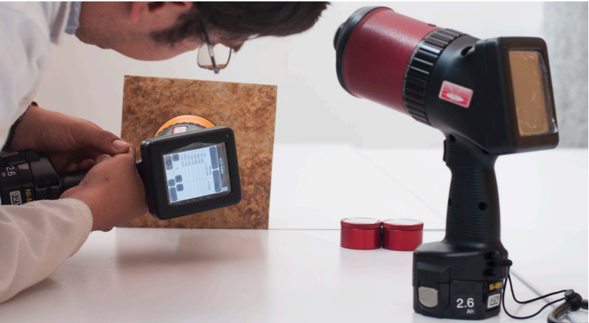
FIGURA 22. Reflectómetro solar y emisómetro térmico bajo las normas ASTM E903 y la ASTM E408.
