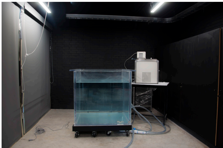
FIGURA 31. Tanque ambiental para la realización de estudios de ventilación natural en donde se utiliza el equipo de baño térmico para el calentamiento e enfriamiento de agua.
