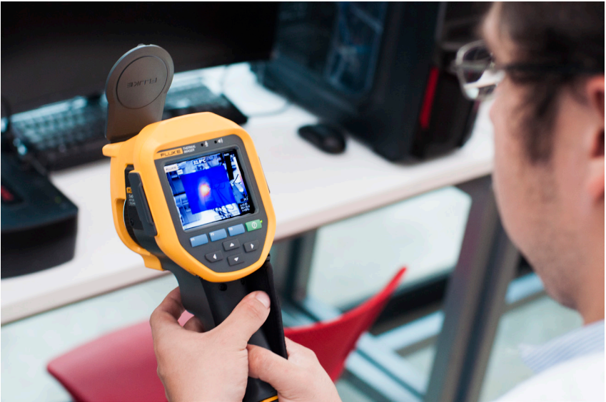
FIGURA 25. Cámara termográfica FLUKE.
