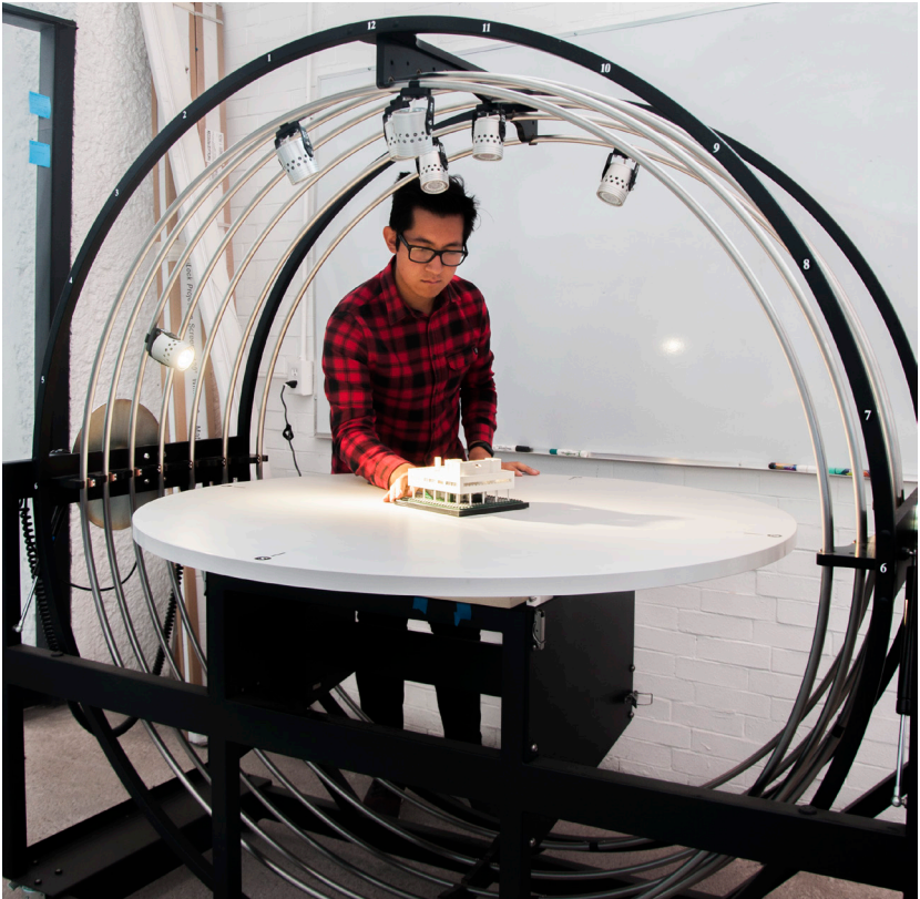
FIGURA 20. Heliódón High Precisions.
