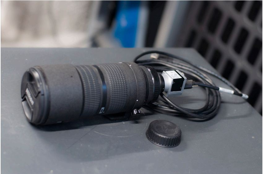
FIGURA 30. Cámara NI-BASLER acA con lente telescópico para la captura de imágenes por medio del método de Schlieren Sintético.
