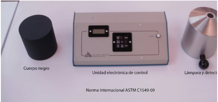
FIGURA 5. Reflectómetro solar bajo la norma ASTM C1549-09.
