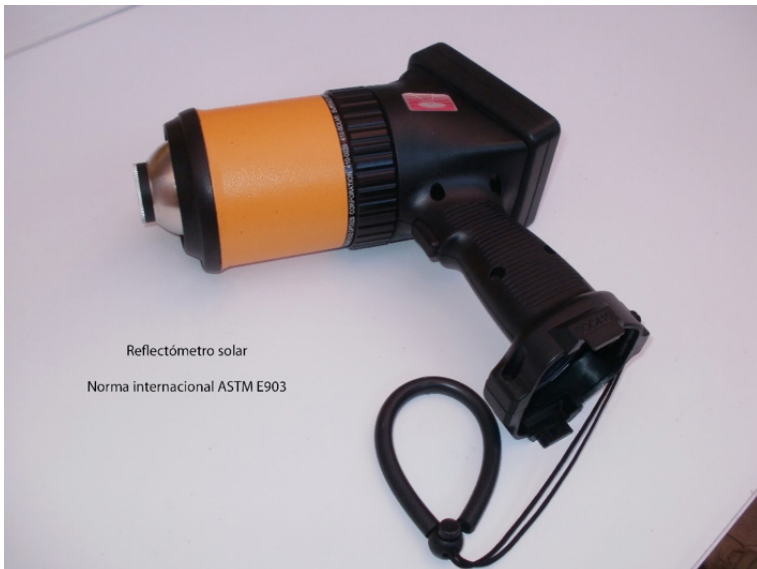
FIGURA 4. Reflectómetro solar bajo la norma ASTM E903.
