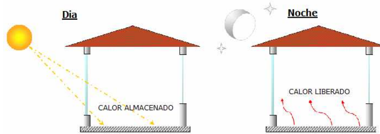
Figura 4: Esquema del funcionamiento de la Masa Térmica en INVIERNO
